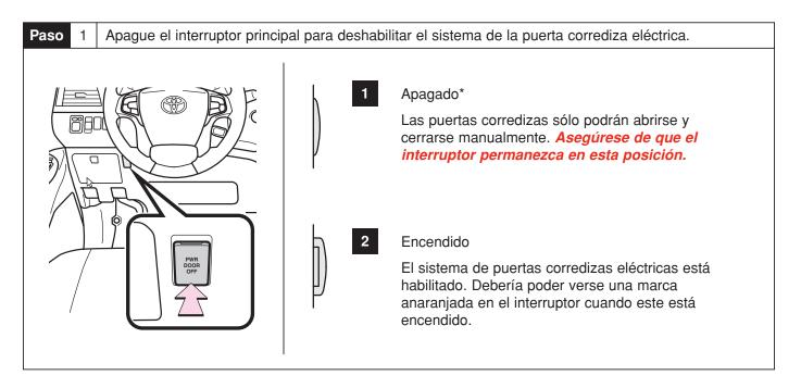
\*: La función eléctrica de la puerta trasera eléctrica estará deshabilitada mientras el interruptor esté en esta posición. La puerta trasera eléctrica aún puede usarse manualmente. Si experimenta la condición descrita anteriormente, le recomendamos que empuje la palanca mecánica de la puerta corrediza eléctrica, tal como se describe a continuación, y que cierre la puerta manualmente. Luego, lleve el vehículo a su concesionario Toyota autorizado local para que realicen un diagnóstico.
